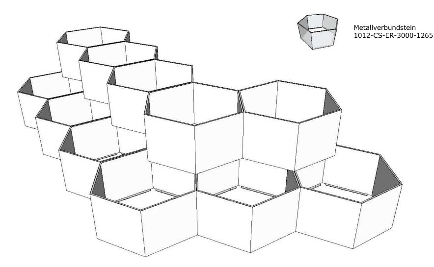
Metalltrockenmauer aus Cortenstahl/Edelrost, Wst.Nr.18965
