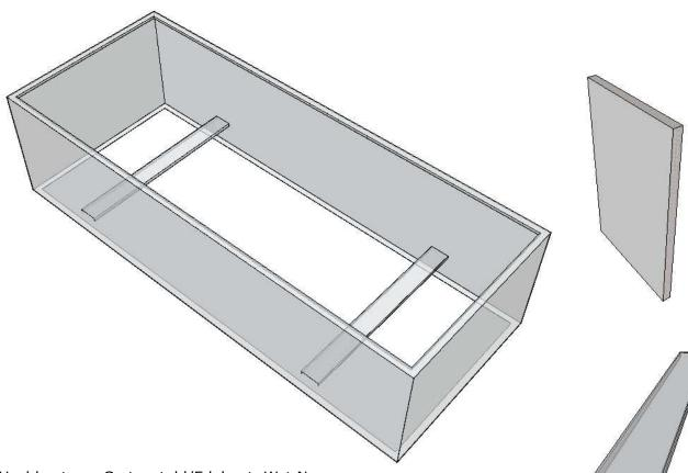
Hochbeet aus Cortenstahl/Edelrost, Wst.Nr. 1.8946, Stärke 2,5mm, oberer Rand u-förmig gekantet zur Aufnahme der Isolierung. Mit eingearbeiteten Aussteifungsrippen, ohne Boden L/B/H 2500/1000/650mm
