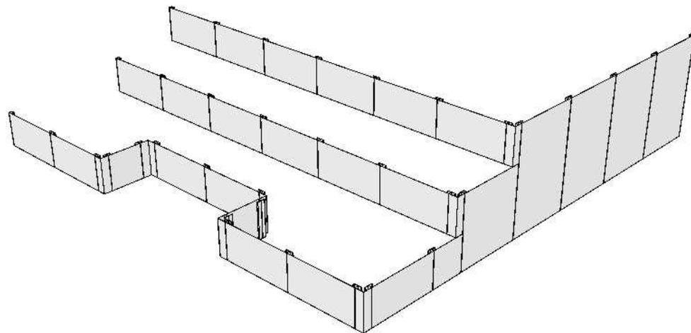
Stützmauer aus Cortenstahl/Edelrost,
