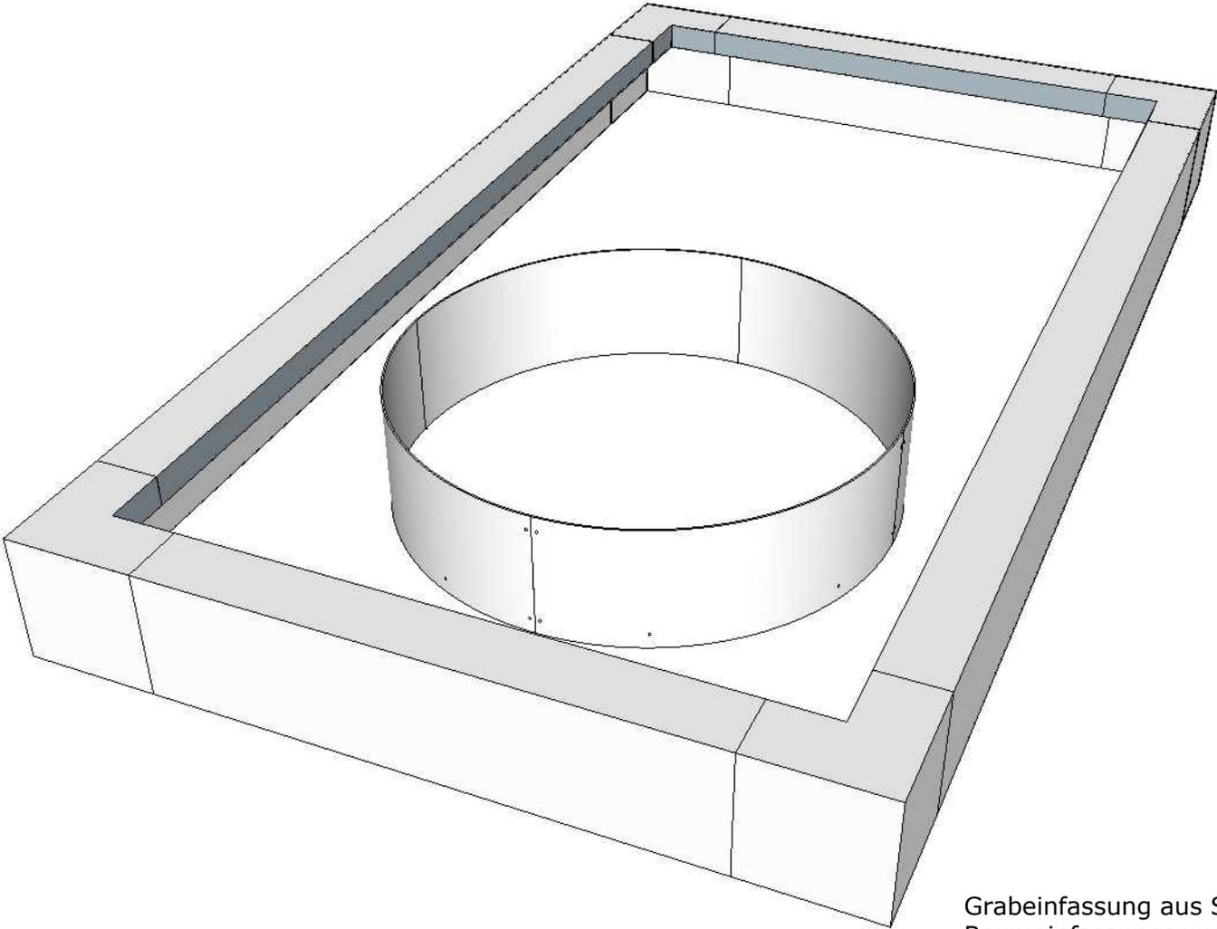
Grabeinfassung aus Sonderprofilen 1444 und Baumeinfassungsprofil 1011, Cortenstahl/Edelrost
